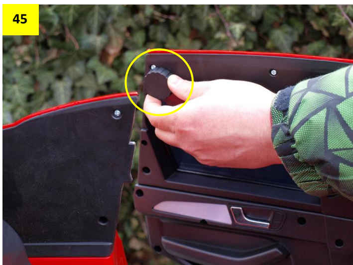
Obr. 46 a 47: Před stažením ochranných fólií nápisy zahlaďte prstem. Teprve až poté fólie opatrně stáhněte.
