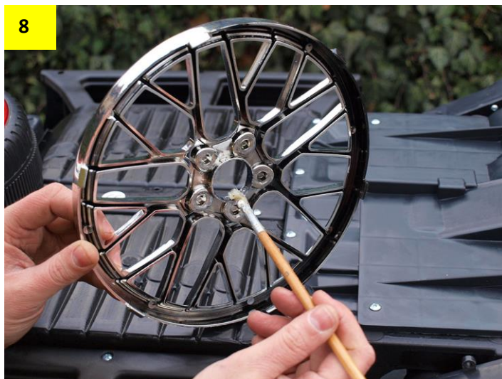
Obr. 10: Poklice nasadte na kola. Pozor, jisticí tlačítka musí jít volně zamáčknout.
