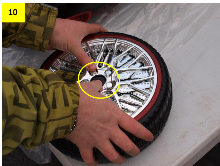
Obr. 10: Poklice nasadte na kola. Pozor, jisticí tlačítka musí jít volně zamáčknout.
