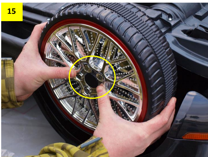
Obr. 16: Přední náprava – na obě strany nasadíte kovové podložky
