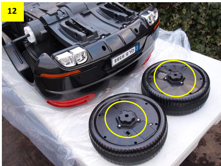
Obr. 11: Jisticí tlačítka na kolech musí jít volně zamáčknout (případně zatlačte na poklici, dokud se tlačítko nevrátí volně zpět)
