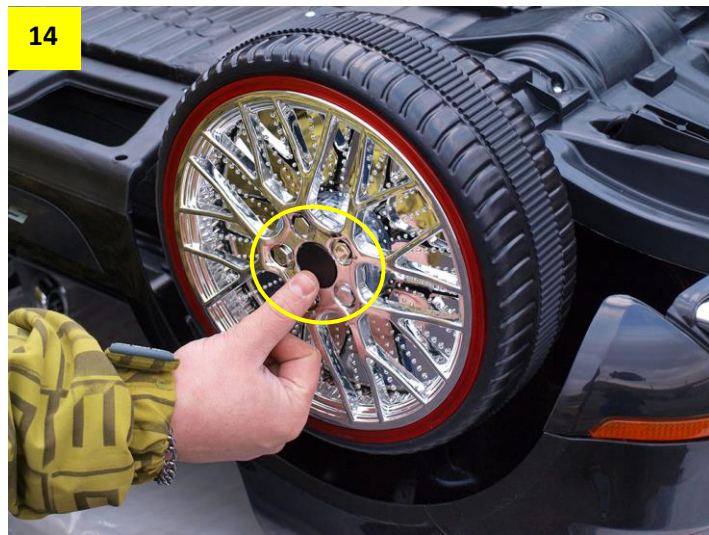
Obr. 15: Víčko musí po zajištění cvaknout. Správné zajištění vyzkoušíte zataháním za kolo.
