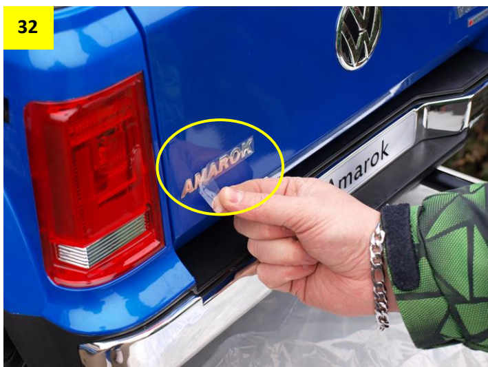
Obr. 32 a 33: Před stažením fólií z nápisů AMAROK (vlevo) a V6 TDI motion (vpravo) nápisy zahladíte prstem. Fólie poté opatrně a pomalu stáhněte.
