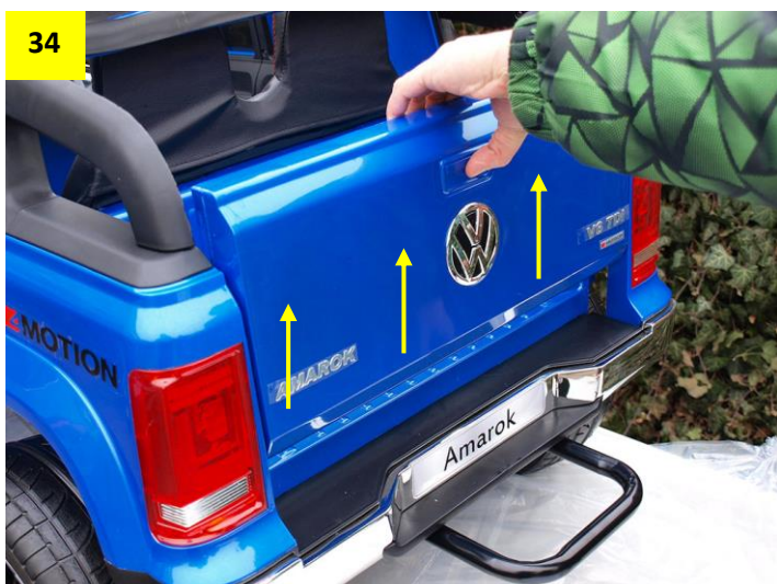
Obr. 34 a 35: Pro otevření zadních dvířek je nejprve nutné je nadzvednout. Teprve až poté je možné je sklopit.
